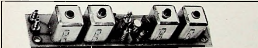
WV-10 - 27 MHz ANTENNE-VERSTERKER, ter verbetering van ontvangst bij alle "CB-bakken". Ekstra versterking voor wereld-ontvangers en de WT-8 tuner e.d. Versterking: minimaal 18 dB Kringen : 4 gepiekt op 27 MHz. Prijs f 47,75
